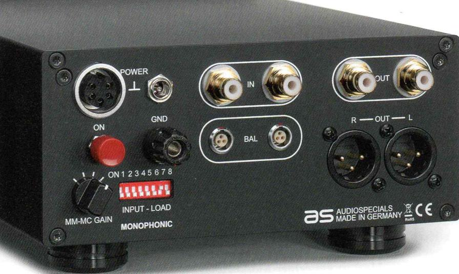
Auch hier findet sich wieder der aufgeräumte Rücken mit praktischen und sinnvollen Anschlüssen sowie Einstellmöglichkeiten. Standardmäßig kommt der Monophonic mit einem Steckernetzteil, der rote Knopf schaltet das Gerät ein. Wer schon einen Phonolab mit PSU 1.2 hat, schließt seinen Monophonic dort an
